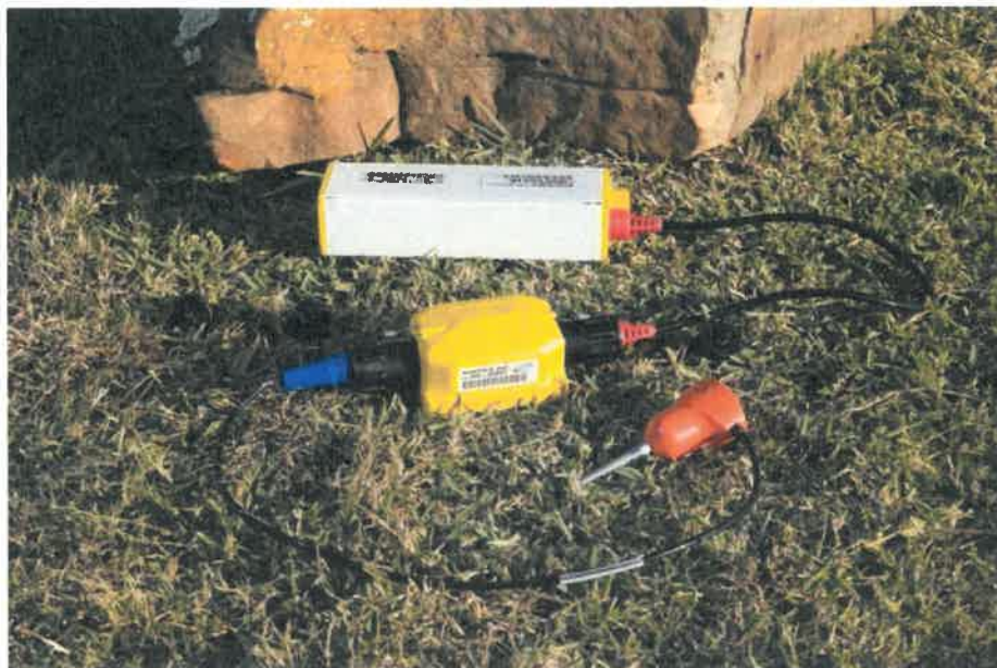
Kihelyezett terepi mérőpont, geofon és adatgyűjtő elektronika
